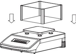
**PASO 2** Sitúe su cabina corta-aires guiándose a través de unas líneas de color rojo señaladas encima del adhesivo, cuidadosamente presione y gire en el sentido de la agujas del reloj la cabina corta-aires tal y como se muestra en la figura.
