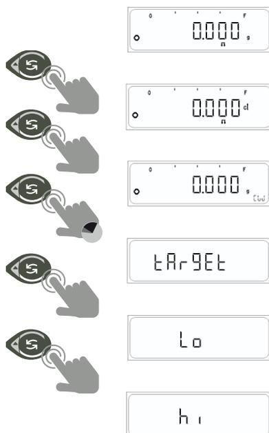
Esta característica se utiliza para comprobar si la muestra corresponde a un objetivo preprogramado o está en un rango específico de tolerancia.
