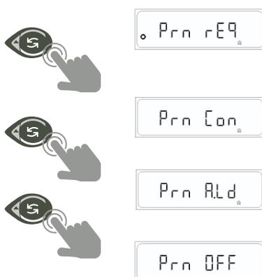
Prn. Req El próximo valor posible estable será transferido después de apretar la tecla Imprimir
