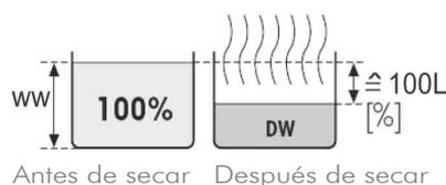
El contenido de humedad de la muestra aparece en pantalla ( e impreso) como un porcentaje del peso neto ( =ww= peso inicial= 100%). Cuando los resultado se imprimen, el contenido de humedad se designa 100L % ( Pérdida) ( ej. -11.35 100.00L%) y se muestra como un valor negativo.
