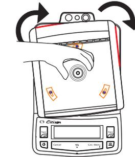
**PASO 3** Mientras sitúe la cabina corta-aires sobre la báscula asegúrese de no dañar el punto de carga de peso.
