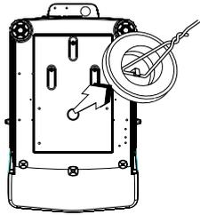
El orificio de pesaje inferior se sitúa en la parte inferior de la báscula
