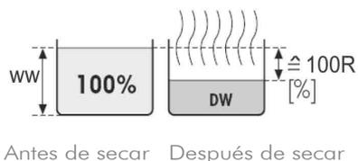
El contenido seco de la muestra aparece en pantalla ( e impreso) como un porcentaje del peso húmedo ( ww= peso inicial= 100%). Cuando se imprimen los resultados , el contenido seco se designa 100R% ( Residuo) (ej. 88.65 100.00R%)
