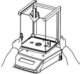
**PASO 1** Abra su nueva báscula y la cabina corta-aires. Verá un cierre de montaje en el cuerpo de la báscula y la placa de cierre montada por debajo de la cabina corta-aires.
